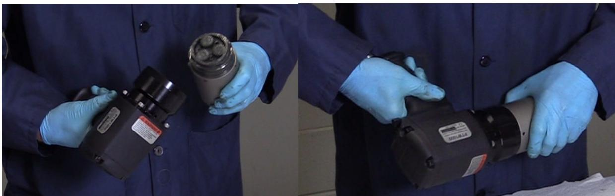
planetarios de primera etapa, luego coloque la junta tórica en el adaptador. Observe la ranura de las bolas a través del orificio del tornillo para verificar que las piezas están unidas por completo.
