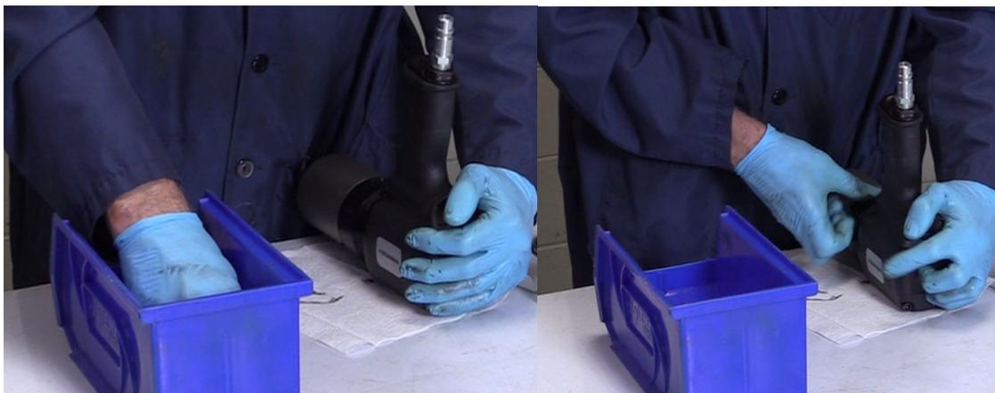
Inserte las 35 bolas a través del orificio del tornillo; gire de vez en cuando la caja de engranajes para que caigan las bolas, o apriete las bolas a mano si es necesario.
