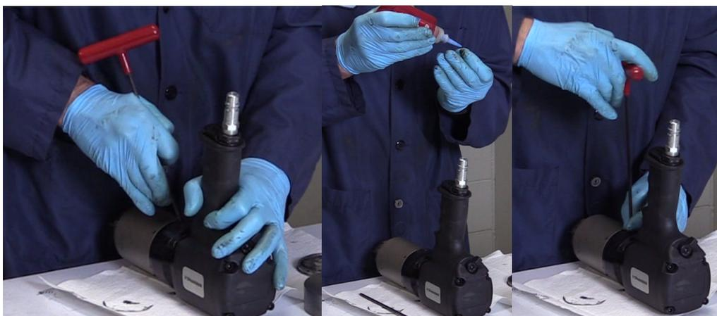
Después de insertar todas las 35 bolas, empújelas a ambos lados del orificio con una llave Allen para que haya un espacio abierto debajo del tornillo de ajuste. Aplique una gota de Loctite® 242 en el tornillo de ajuste y apriete el tornillo de ajuste hasta que haga contacto con el anillo de rodamiento. A continuación, desenrosque el tornillo de ajuste un cuarto de vuelta.
