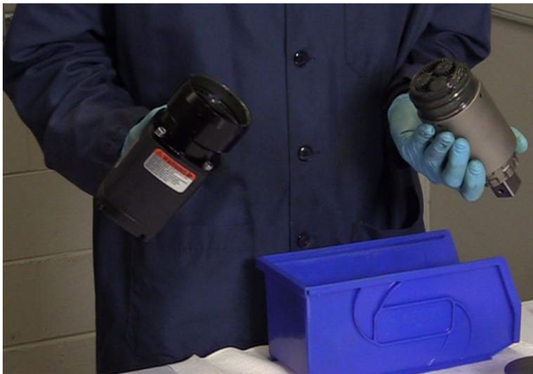
Una vez se hayan extraído las bolas, la caja de engranajes se separará del adaptador. Sostenga la caja de engranajes con el lado de salida inclinado hacia abajo para evitar que se caigan los engranajes.
