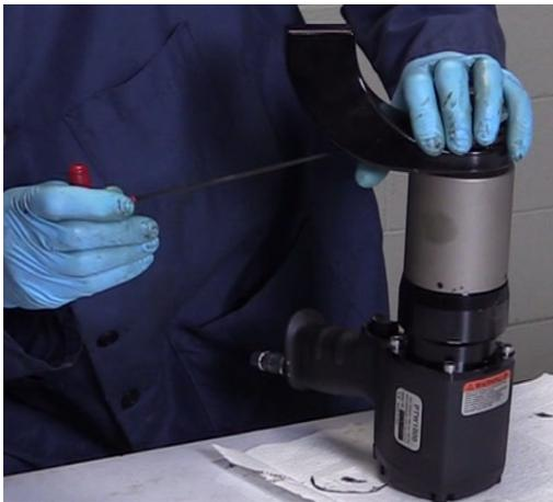
Vuelva a colocar el brazo de reacción usando una llave Allen de 1/8" para apretar el tornillo de ajuste lo suficiente para que atrape la paleta de la lengüeta. No lo apriete excesivamente.
