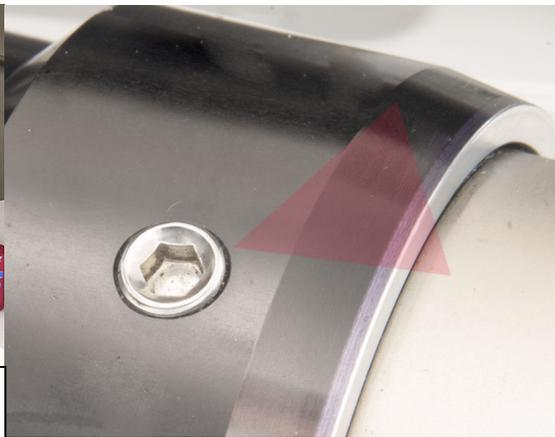
Quite la caja de engranajes desenroscando el tornillo de ajuste en la parte inferior de la caja del adaptador con una llave Allen® de 3/16".
