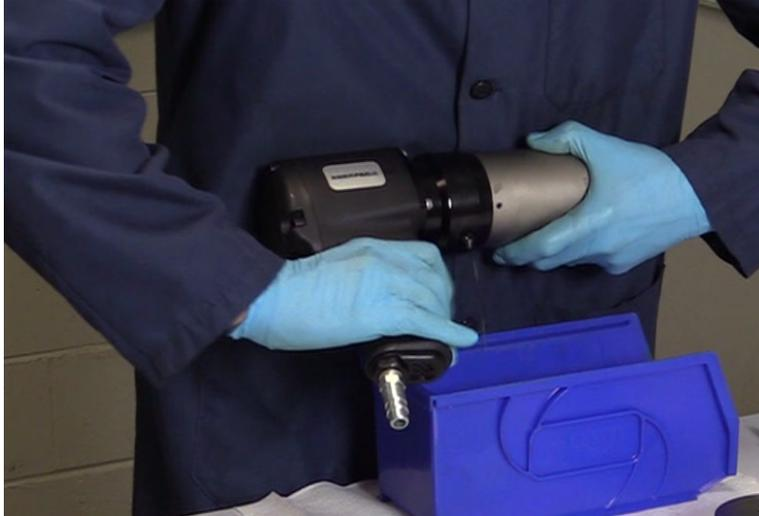
Deje que las 35 bolas de la junta rotativa se caigan del adaptador por el orificio del tornillo de ajuste manteniendo la herramienta en una posición de trabajo horizontal y girándola y balanceándola hasta que se caigan todas las bolas. La aplicación de fuerzas axiales mientras gira la herramienta puede facilitar este proceso.
