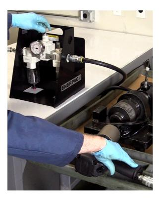
Verificare che il braccio di reazione sia fissato all'attrezzo, quindi installare il supporto di calibratura usando la vite adeguata all'attacco quadro della chiave e al supporto.
