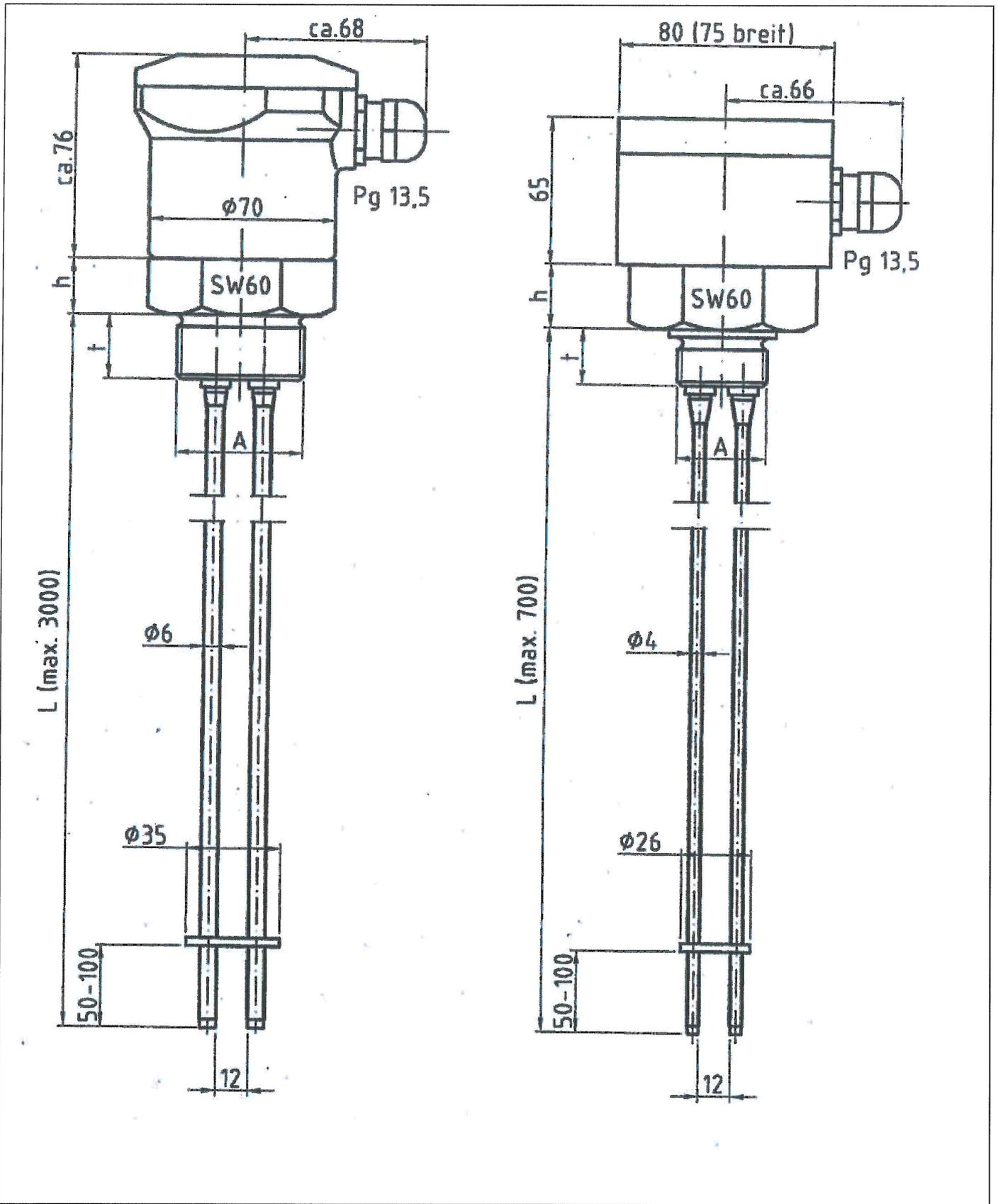
Standaufnehmer (konduktive Stabelektroden) vom Typ "NE-W.2." und Messumformer als Standgrenzschalter von Überfüllsicherungen
