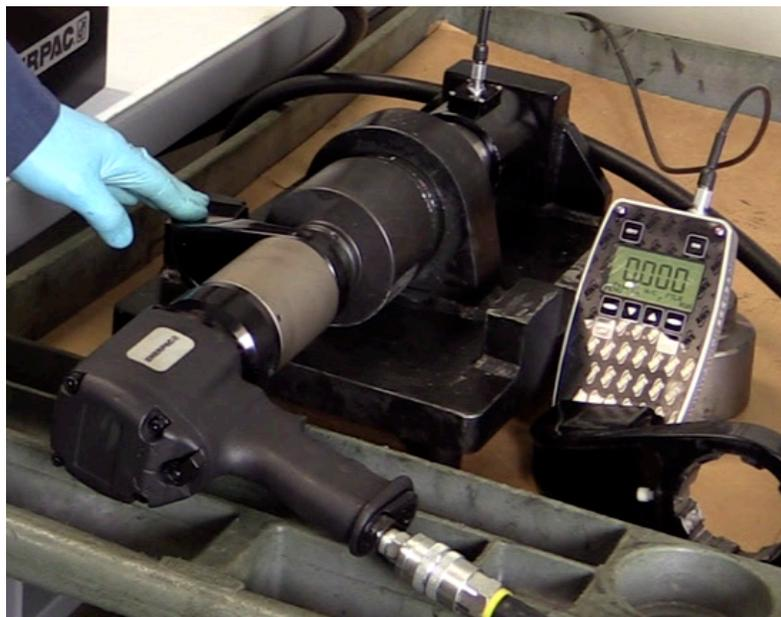
2 : Réglez la pression d'air à environ 0,69 bar (10 psi) en dessous de la pression cible en laissant l'outil fonctionner librement.
