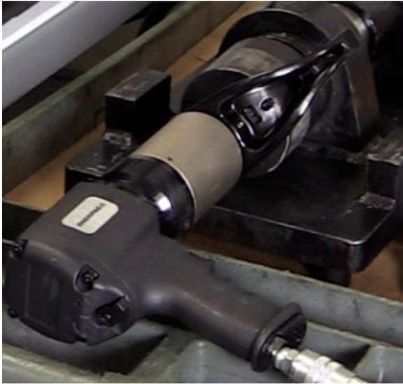
Appuyez sur le déclencheur et relevez le couple qui apparaît sur l'afficheur quand l'outil cale.
