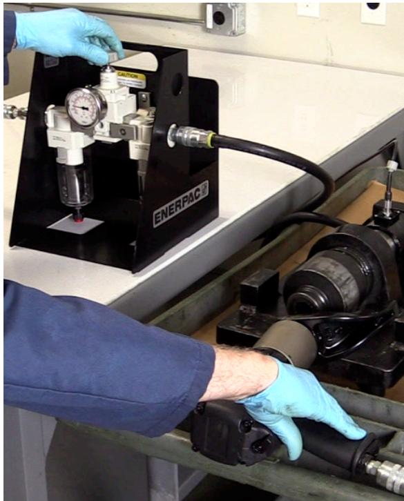
Vérifiez que le bras de réaction est fixé à l'outil, puis montez l'outil sur le pied d'étalonnage en utilisant la douille appropriée pour faire interface entre la douille femelle de la clé et le pied.
