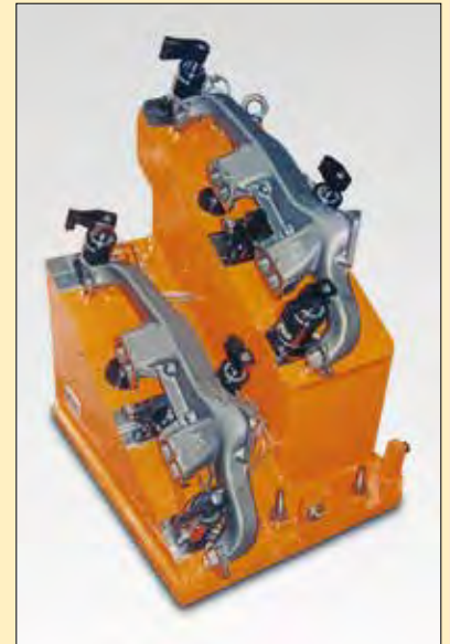
■ MPTL-100 und MPTR-100 Collet-Lok®-Schwenkspannzylinder werden zur sicheren Einspannung dieser Auspuffkrümmen verwendet.
