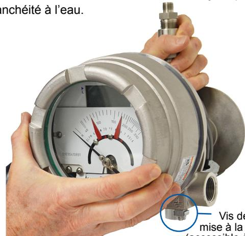
Vis de mise à la terre (accessible à l'avant du débitmètre)
