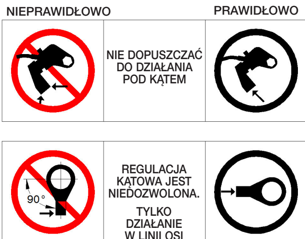
Ryc 4.4-2 Pozycjonowanie narzędzia z sześciokątem z ramieniem reakcyjnym
