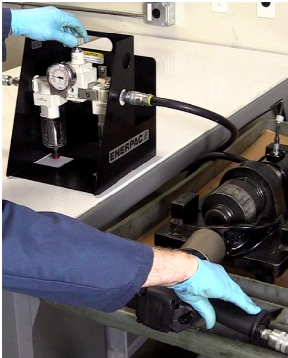
Asegúrese de que el brazo de reacción esté fijado a la herramienta y, a continuación, monte la herramienta en el banco de calibración usando el dado correspondiente a la interfaz entre el cuadrante y el banco.
