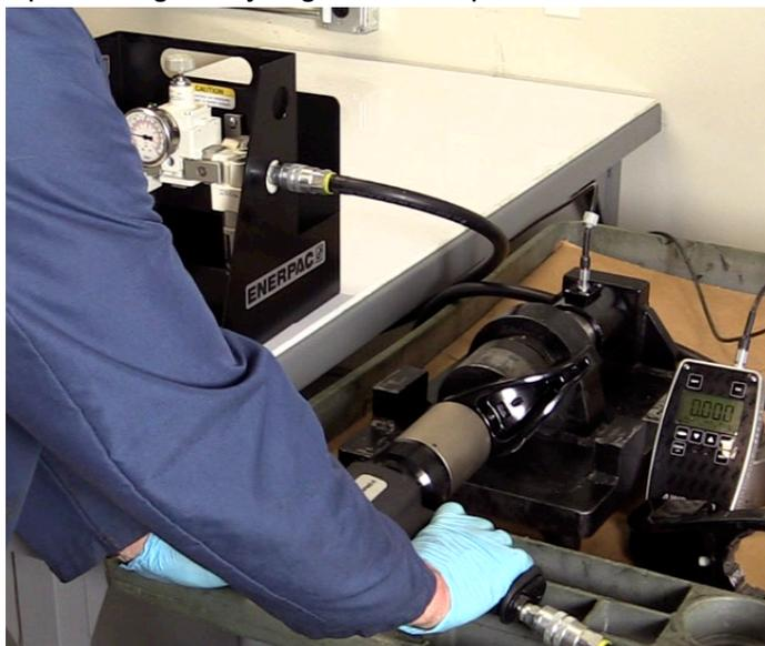
Repita este proceso para obtener de 3 a 5 puntos de datos. El promedio de estos valores proporciona un punto de calibración. Repita este proceso a incrementos de 10 psi (0,69 bar) hasta alcanzar el torque nominal total de la llave respectiva.
