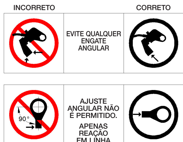
Fig. 4.4-2 Reação da ferramenta sextavada com braço de reação
