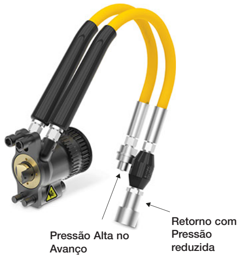
c. Engates rápidos para mangueiras de chaves de torque do tipo rosqueados e com válvula de alívio
