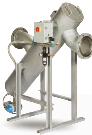
Siebkorbfiltermodell MCS-1500 für Hochleistungsanwendungen. Die magnetisch gekoppelte Stellvorrichtung macht dynamische Dichtungen überflüssig.
