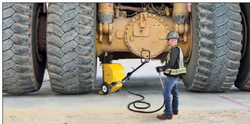
◀ El sistema de elevación portátil Pow'R-LOCK serie PL.
