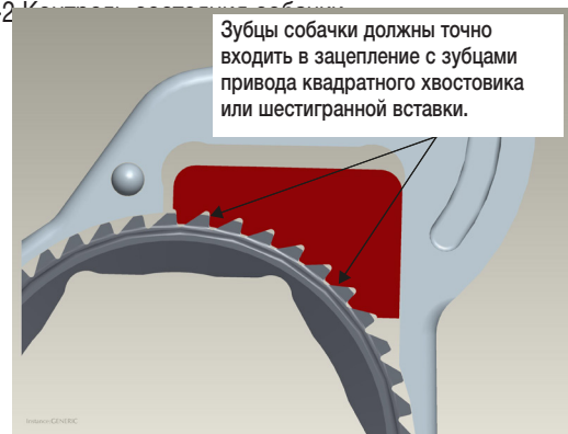
Рис. 5.4-2 Контроль зацепления собачки
