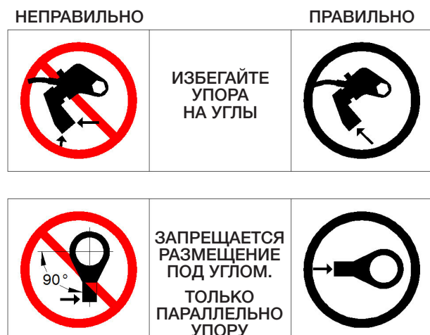
Рис. 4.4-2 Организация упора для гайковерта с шестигранной
