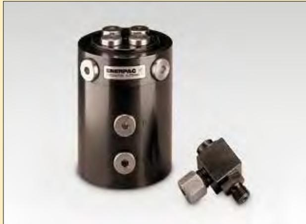
**I giunti rotanti sono connessioni appositamente progettate per trasferire fluido pressurizzato da una linea di alimentazione permanente ad un dispositivo in rotazione. Vengono usati per dispositivi di bloccaggio o supporto quali, ad esempio, le attrezzature installate su tavole portapezzo rotanti.**
