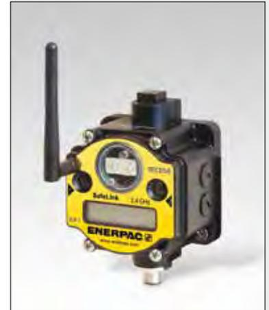
▶ Le unità RECEIVE SafeLink possono fornire le uscite utilizzando il protocollo standard Modbus RTU RS-485. Questa uscita utilizza il connettore 5 pini sull'unità RECEIVE. Se il protocollo Ethernet è preferito, un PONTE ETHERNET è disponibile per convertire Modbus RTU R-485 in ETHERNET IP o Modbus TCP/IP.
