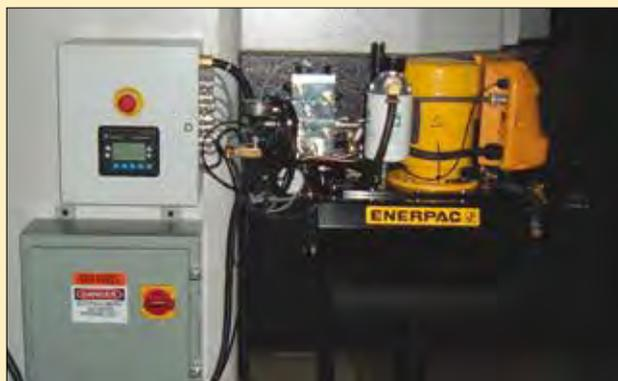
■ Un innesto automatico a 4-vie auto connesso al ricevitore, montato sul lato di una apparecchiatura pallettizzata.
