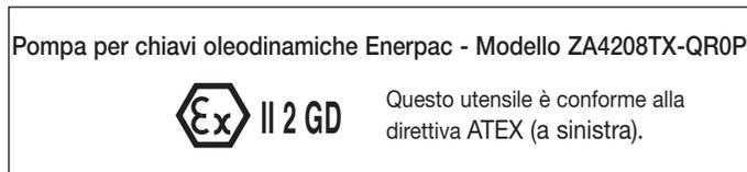
Questo modello di pompa per chiavi oleodinamiche Enerpac Serie ZA4T è collaudato e certificato in base alla direttiva ATEX 2014/34/UE. La protezione antiesplorazione è per le apparecchiature appartenenti al gruppo II, categoria 2 (zone pericolose 1) in ambienti con presenza di gas e/o polvere. Ogni pompa della Serie ZA4T reca i seguenti marchi:
