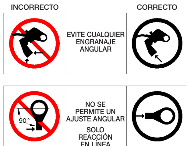
Fig. 4.4-2 Reacción de herramienta hexagonal con brazo de reacción
