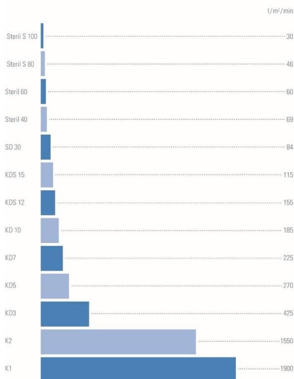
Bedingungen:  $\Delta p = 100 \text{ kPa (1 bar)}$ , Medium: Wasser bei 20 °C
