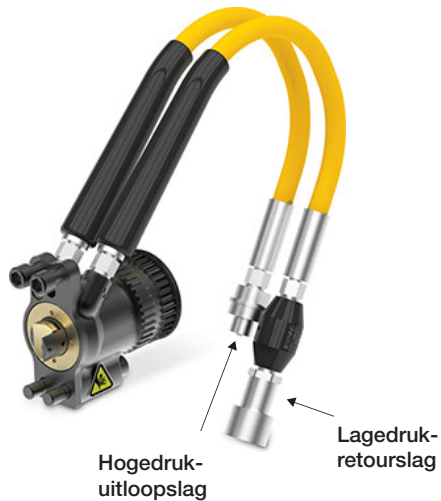
c. Snelkoppelingen voor de slangen van de momentsleutelaandrijving, schroeftype met drukbegrenzingsventiel
