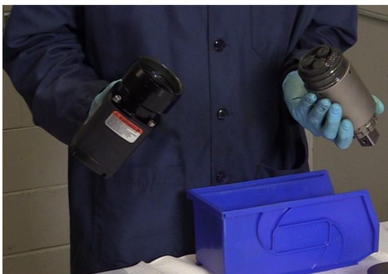
Una volta rimosse le sfere, la scatola del cambio si separerà dall'adattatore. Assicurarsi di tenere la scatola del cambio con il lato dell'uscita rivolto verso il basso per evitare che gli stadi del cambio fuoriescano.
