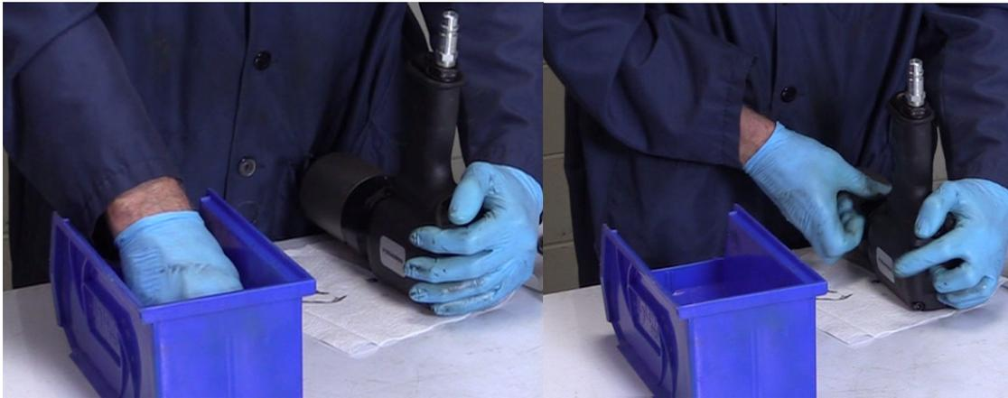
Inserire le 35 sfere nel foro della vite di fissaggio. Ruotare di tanto in tanto la scatola del cambio per fare sì che le sfere cadano oppure premere con la mano, se necessario.
