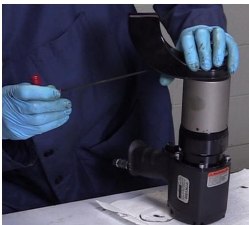
Riattaccare il braccio di reazione usando una chiave a brugola da 1/8" per stringere la vite di fissaggio finché non arriverà alla spalla della chiavetta. Non serrare eccessivamente.
