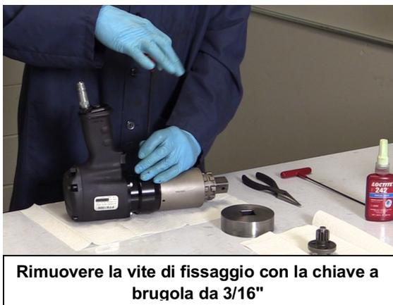
Rimuovere la vite di fissaggio con la chiave a brugola da 3/16"
