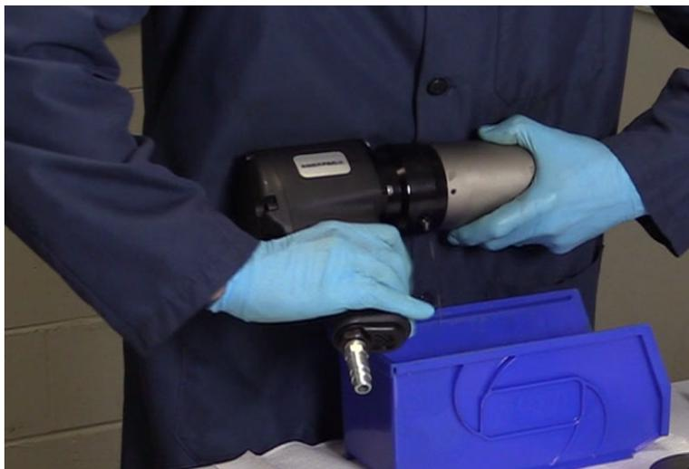
Fare cadere le sfere del giunto girevole dall'adattatore attraverso l'apertura della vite di fissaggio, tenendo l'attrezzo in posizione di lavoro orizzontale e ruotandolo per lasciare fuoriuscire le sfere. L'applicazione di forze assiali durante la rotazione può aiutare il processo.
