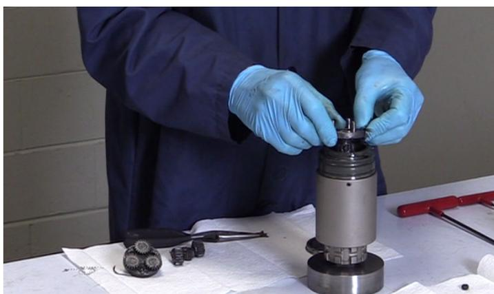
**Installare il supporto dell'ingranaggio con l'ingranaggio centrale rivolto verso il basso**
