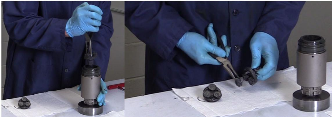
Ripetere le fasi appena descritte per rimuovere il supporto della seconda marcia. Non dimenticare che gli ingranaggi epicicloidali della seconda marcia devono essere rimossi, poiché verranno riutilizzati. Il supporto dell'ingranaggio della seconda marcia è il componente da sostituire.
