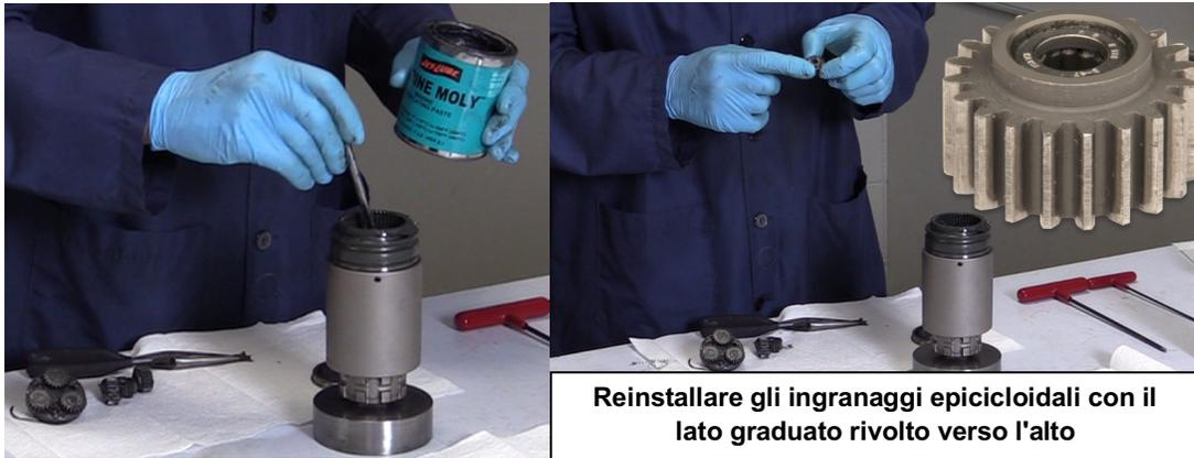
Aggiungere un generoso strato di grasso sui tre perni presenti nel lato superiore del supporto e ricoprire la superficie restante. Fare scivolare gli ingranaggi epicicloidali sui perni del supporto dell'ingranaggio della seconda marcia. **Nota importante:** gli ingranaggi non sono simmetrici. In un'estremità è presente un diametro inferiore. Il diametro inferiore deve essere lontano dal supporto (rivolto verso l'alto) mentre scorre sui perni.
