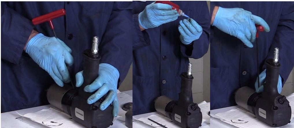
Dopo avere installato tutte e 35 le sfere, spingere le sfere verso una qualsiasi delle estremità del foro usando una chiave a brugola, in maniera tale da creare uno spazio vuoto sotto la vite di fissaggio. Applicare una goccia di Loctite® 242 sulla vite di fissaggio e serrarla finché non arriverà a contatto con la gola della sfera. A questo punto, svitare la vite di fissaggio di un quarto di giro.
