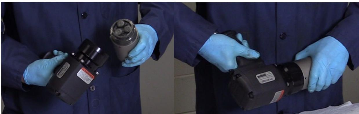
Posizionare l'alloggiamento dell'adattatore del motore sull'alloggio dell'ingranaggio e ruotare per agevolare l'assemblaggio assiale. A tale scopo, l'attrezzo deve trovarsi in posizione di lavoro orizzontale per evitare che gli ingranaggi delle marce escano dalla scatola del cambio o che la rondella cada dall'adattatore del motore. Per prima cosa, allineare i denti dell'ingranaggio
