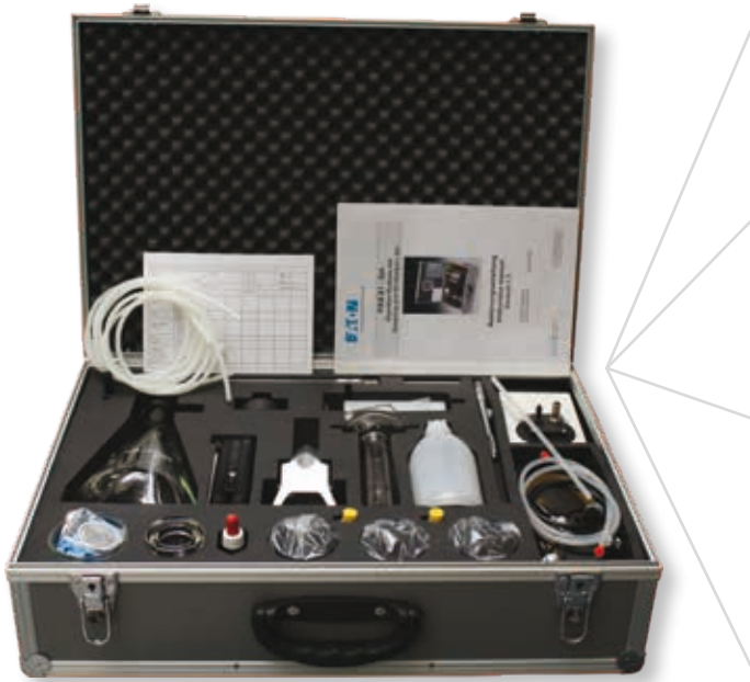
PAS 01-Kit zur Probenentnahme und Ölanalyse Mobiles Mini-Labor zur Durchführung von Fluidanalysen.
