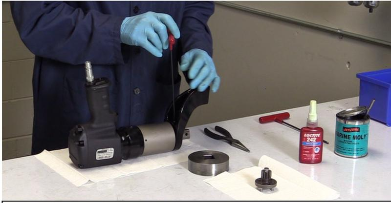
Abstützarm mit einem 1/8" Inbusschlüssel entfernen
