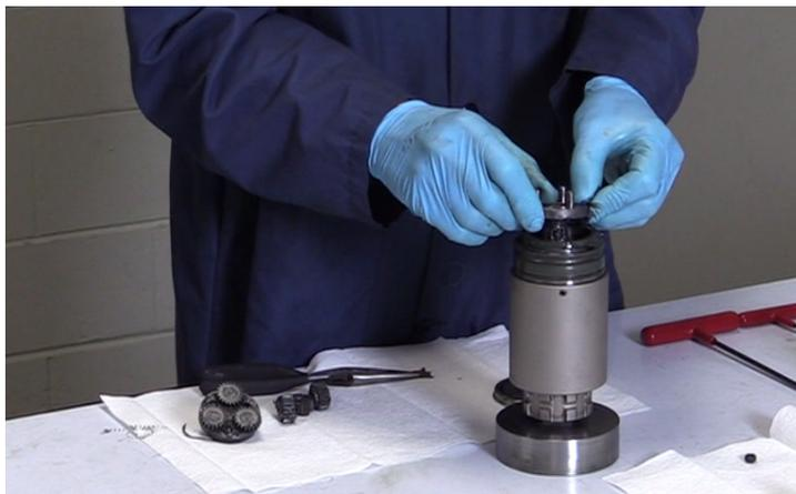
Planetenträger mit dem Sonnenrad nach unten installieren
