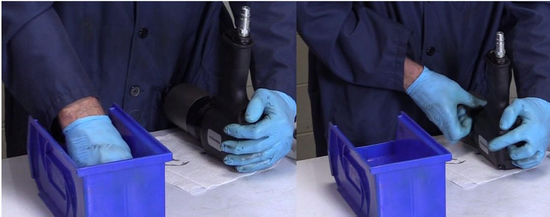
Führen Sie durch die Öffnung der Stellschraube die 35 Kugeln ein. Drehen Sie das Getriebe gelegentlich, damit die Kugeln leichter hinein gelangen oder drücken Sie die Kugeln, falls erforderlich, mit der Hand hinein.
