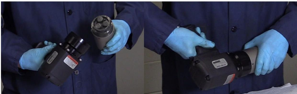
Positionieren Sie das Adaptergehäuse des Antriebs über dem Getriebegehäuse und drehen Sie es, um die axiale Montage zu erleichtern. Dabei sollte sich das Werkzeug in einer horizontalen Arbeitsposition befinden, um zu verhindern, dass die Getriebestufen herausfallen. Richten Sie zuerst die Zähne des Sonnenrads mit den Planetenrädern der ersten Stufe aus. Setzen Sie
