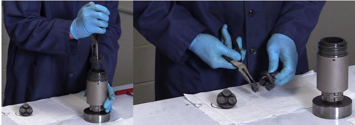
Wiederholen Sie den ersten Schritt, um den Träger der zweiten Stufe zu entfernen. Beachten Sie, dass die Planetenräder der zweiten Stufe nicht entfernt werden müssen, da sie erneut verwendet werden. Der Planetenträger der zweiten Stufe ist die Komponente, die ausgetauscht wird.
