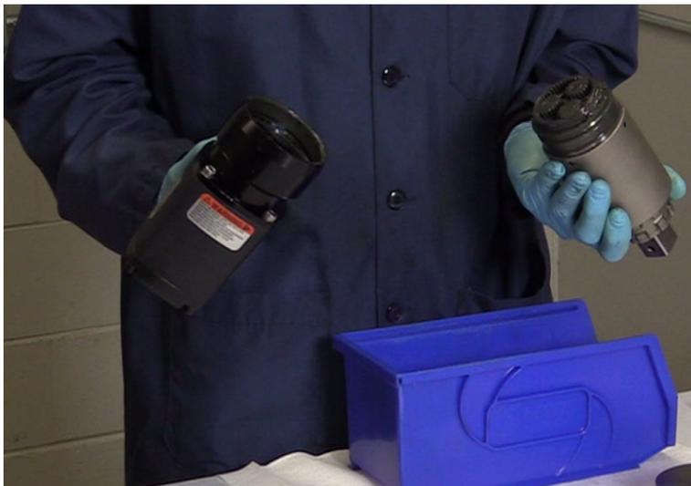
Nach dem Entfernen der Kugeln kann das Getriebe vom Adapter abgenommen werden. Stellen Sie sicher, dass das Getriebe mit der Abtriebsseite nach unten abgewinkelt ist, um zu verhindern, dass die Getriebestufen herausfallen.
