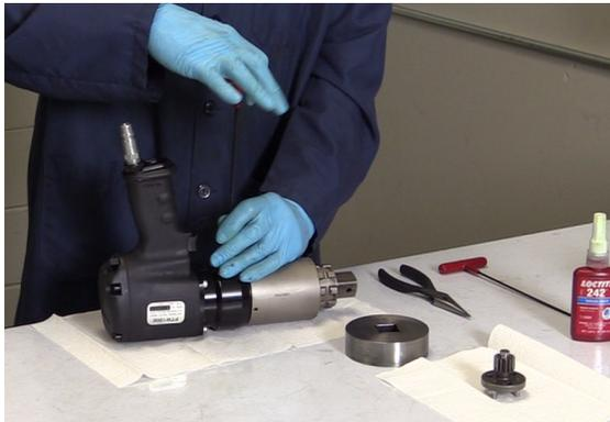
Stellschraube mit einem 3/16" Inbusschlüssel entfernen
