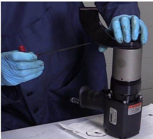
Bringen Sie den Abstützarm wieder an und ziehen Sie die Stellschraube mit einem 1/8" Inbusschlüssel soweit fest, dass diese in die Schulter der Keilwelle greift. Nicht zu fest anziehen.
