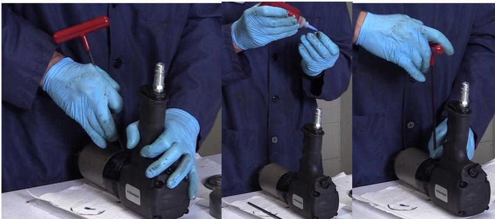
Wenn alle 35 Kugeln eingeführt sind, drücken Sie die Kugeln mit einem Inbusschlüssel auf beide Seiten der Öffnung von dieser weg, sodass sich unter der Stellschraube ein Freiraum befindet. Geben Sie einen Tropfen Loctite® 242 auf die Stellschraube und ziehen Sie diese an, bis sie den Kugelkäfig berührt. Drehen Sie die Stellschraube anschließend eine Vierteldrehung zurück.
