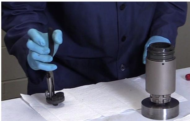
Setzen Sie den Träger der ersten Stufe vorsichtig auf einem sauberen Handtuch ab. Beachten Sie, dass die Planetenräder nicht axial zurückgehalten werden und abrutschen können.
