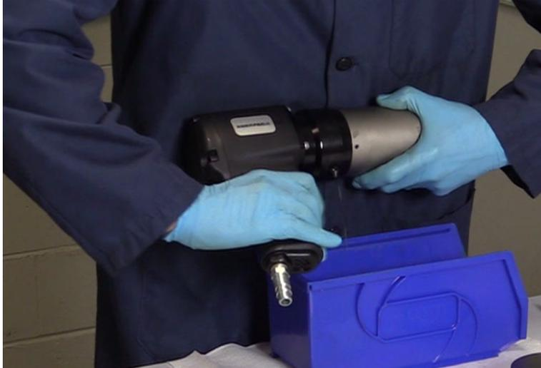
Entfernen Sie anschließend die 35 Gelenkkugeln aus dem Adapter, indem Sie das Werkzeug in horizontaler Position drehen und schütteln, sodass die Kugeln durch die Öffnung der Stellschraube herausfallen können. Durch Aufwenden von Axialkräften während des Drehens kann dieser Vorgang beschleunigt werden.
