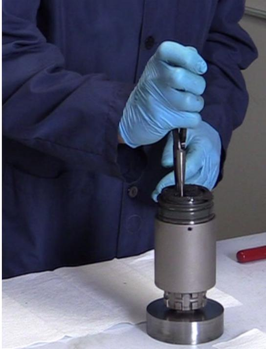
Positionieren Sie das Getriebe auf der Abtriebsseite (zur Fixierung des Getriebes kann ein Einsatz verwendet werden: verwenden Sie einen 3/4" Einsatz für TW1000-75; verwenden Sie einen 1" Einsatz für TW1000, TW2000 und TW3000 sowie einen 1,5" Einsatz für TW6000). Stecken Sie die Spitzen der Spitzzange in zwei der drei Löcher zwischen den Planeten des Trägers der ersten Stufe. Ziehen Sie die Träger-Einheit nach oben aus dem Getriebegehäuse heraus.
