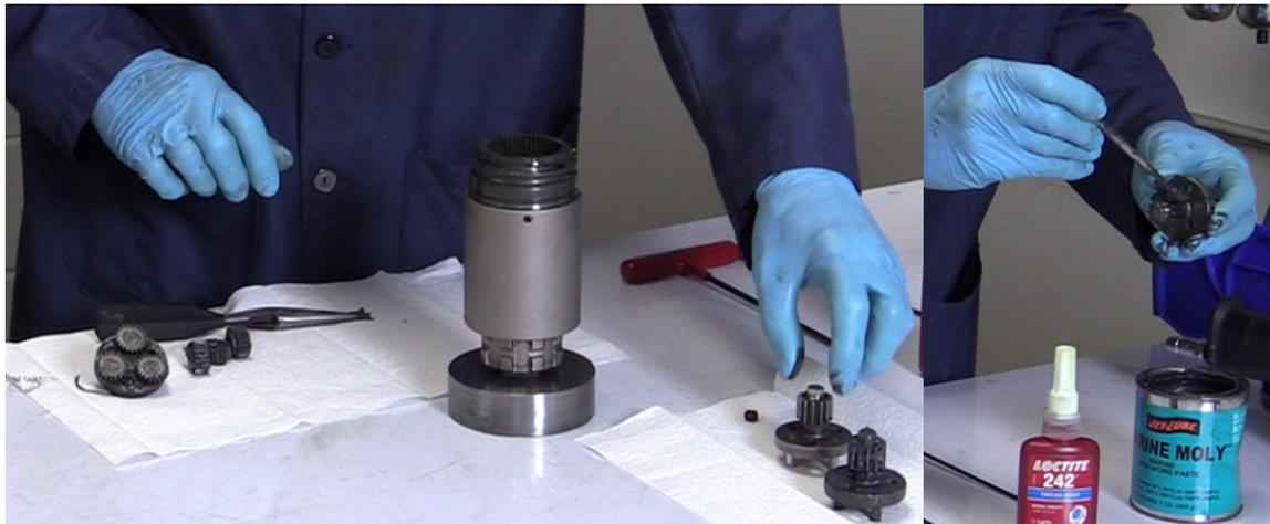
Entsorgen Sie den alten Planetenträger der zweiten Stufe. Nehmen Sie anschließend den neuen Planetenträger der zweiten Stufe und tragen Sie auf die Verzahnung großzügig schwarzes Marine Moly™-Fett (oder gleichwertiges Produkt) auf. Tragen Sie eine dünne Schicht auf die gleiche Seite und auf den Außendurchmesser auf.
