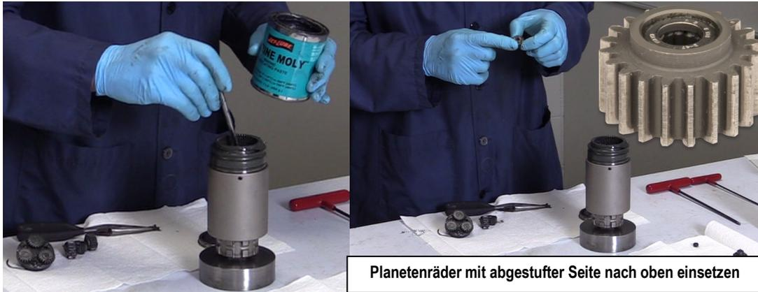
Tragen Sie großzügig Fett auf die drei Stifte an der Oberseite des Trägers auf. Tragen Sie eine Schicht auf die verbleibende Oberfläche auf. Schieben Sie die Planetenräder auf die Stifte des Planetenträgers der zweiten Stufe. **Wichtiger Hinweis:** Die Räder sind nicht symmetrisch. An einem Ende ist der Durchmesser untersetzt. Wenn die Planetenräder auf die Stifte geschoben werden, muss der untersetzte Durchmesser vom Träger weg (nach oben) weisen.
