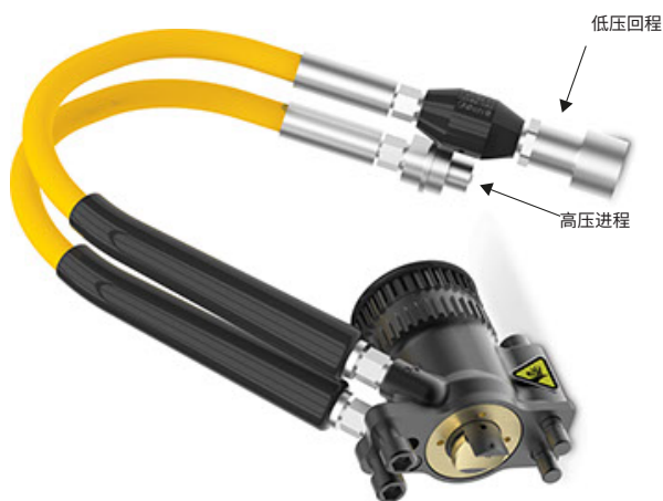
图 4.6-3 扭矩扳手动力头 接口
