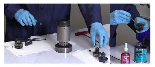
Mettez au rebut l'ancien support d'engrenage de second niveau, puis prenez le support d'engrenage de second niveau neuf et appliquez de la graisse noire Marine Moly™ (ou similaire) généreusement sur la denture. Appliquez une légère couche sur la même face et sur le périmètre externe.
