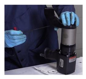
Remettez en place le bras de réaction à l'aide d'une clé Allen de 1/8" pour visser la vis de réglage juste assez loin pour qu'elle attrape l'épaulement de la cannelure. Ne serrez pas trop.
