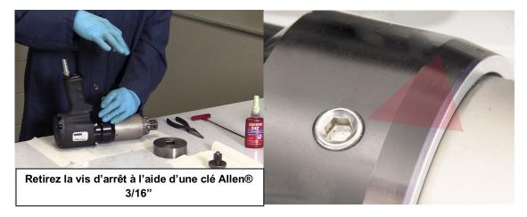
Déposez la boîte d'engrenages en dévissant la vis de réglage au fond du boîtier d'adaptateur avec une clé Allen® de 3/16".
