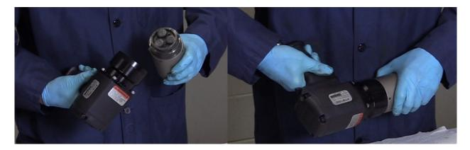
Placez le carter d'adaptateur moteur sur le carter d'engrenages et faites pivoter pour permettre l'assemblage axial. Cela doit être réalisé avec l'outil en position de fonctionnement horizontale afin d'éviter que les niveaux d'engrenage ne sortent de la boîte d'engrenages ou que la rondelle ne sorte de l'adaptateur moteur. D'abord, alignez les dents de la roue solaire sur les roues satellites de premier niveau, puis posez le joint torique dans l'adaptateur. Observez la gorge à
