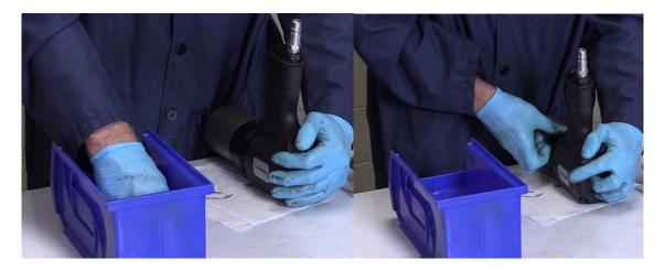
Insérez les 35 billes dans le trou de vis de réglage ; faites pivoter occasionnellement la boîte d'engrenages pour faire tomber les billes, ou appuyez à la main sur les billes si nécessaire.
