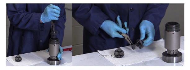
Recommencez l'étape précédente pour démonter le support de second niveau. Attention : les planétaires de second niveau doivent être démontés, car ils seront réutilisés. Le support d'engrenage de second niveau est la pièce à remplacer.
