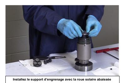
Placez le support d'engrenage de second niveau neuf dans le carter d'engrenages. Faites tourner le support tout en l'abaissant afin pour que la roue solaire s'engrène avec les roues satellites de troisième niveau. Insérez le support aussi loin que possible, tout en vous assurant que la roue solaire et les roues satellites s'alignent correctement.
