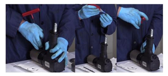
Après avoir remis en place les 35 billes, poussez-les d'un côté du trou grâce à une clé Allen afin qu'il y ait un espace ouvert sous la vis de réglage. Appliquez une goutte de Loctite<sup>®</sup> 242 à la vis de réglage, puis vissez la vis de réglage jusqu'à ce qu'elle entre en contact avec la bague de roulement à billes. Ensuite, dévissez la vis de réglage d'un quart de tour.
