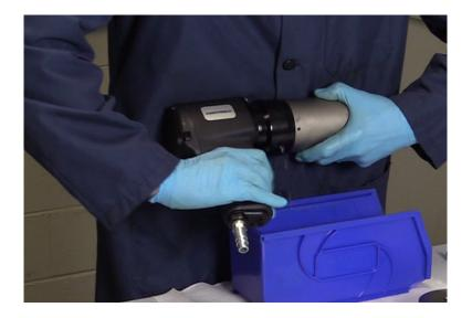
Laissez les 35 billes du raccord tournant tomber de l'adaptateur par le trou de la vis de réglage en tenant l'outil en position de fonctionnement horizontale et en pivotant / bougeant pour faire tomber les billes. Appliquer des forces axiales en tournant peut aider.
