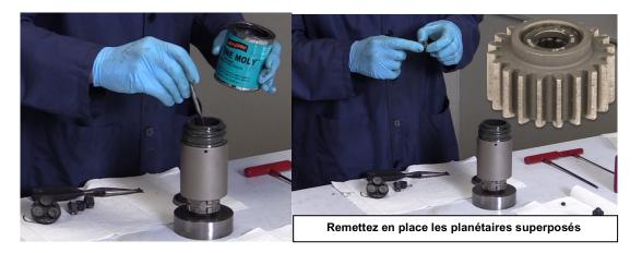
Ajoutez de la graisse généreusement aux trois goupilles sur le dessus du support et appliquezen sur la surface restante. Faites glisser les roues satellites sur les goupilles du support d'engrenage de second niveau. **Remarque importante**: les engrenages ne sont pas symétriques. Il y a un diamètre réducteur à une extrémité. Le diamètre réducteur doit être à l'opposé du support (vers le haut) en glissant sur les goupilles.
